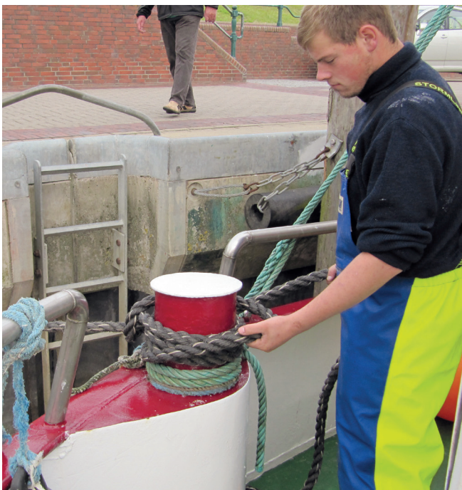
SICHERE BELEGUNG EINES POLLERS
