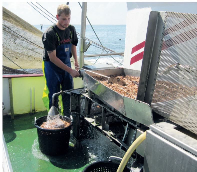
AUSREICHENDER ABSTAND BEI SICH DREHENDEN VERARBEITUNGSANLAGEN
